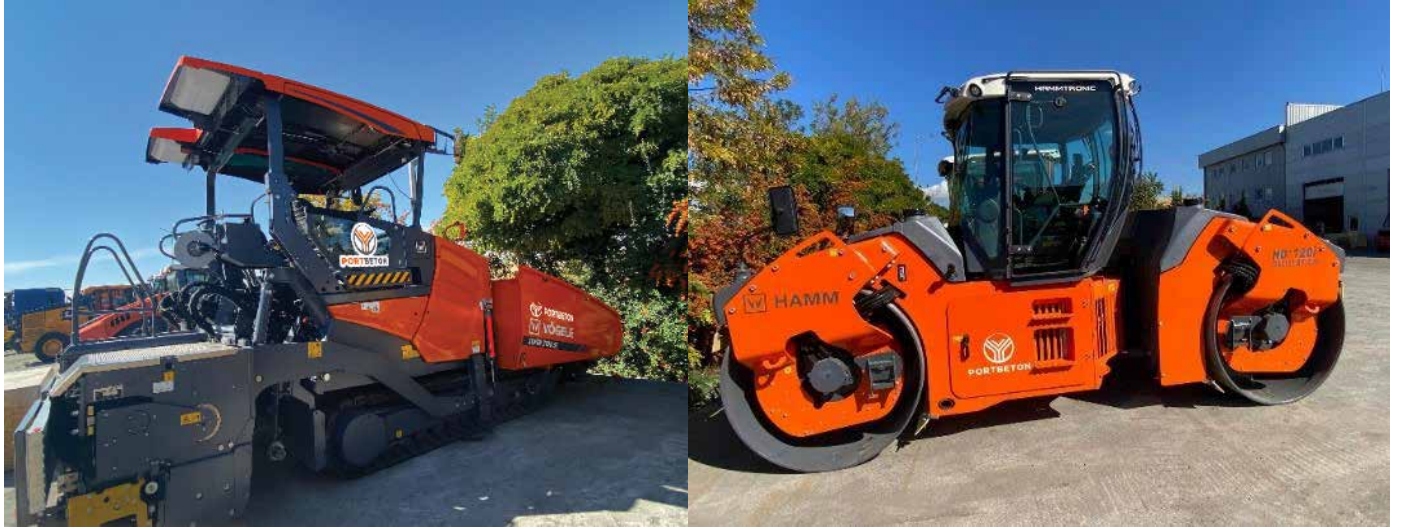
Resim 1. YSB İmalatında Kullanılan Yüksek Sıkıştırma Özelliğine Sahip Serici ve Osilasyonlu Silindir
