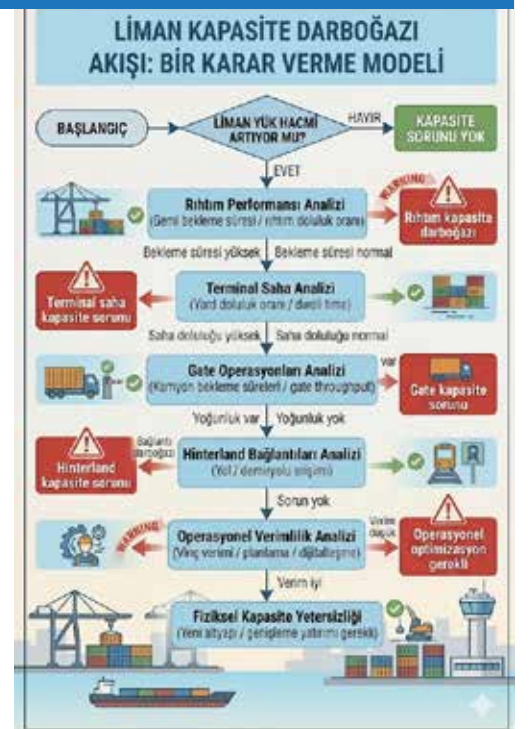
Şekil 3-Liman Kapasite Analizi Akış Diyagramı
